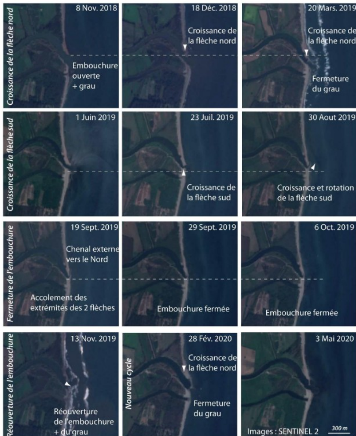
Figure 4: Dynamique naturelle d'ouverture et de fermeture de l'embouchure du Golo, formation de flèches sédimentaires, entre novembre 2018 et mai 2020 (extrait du rapport BRGM précité).
